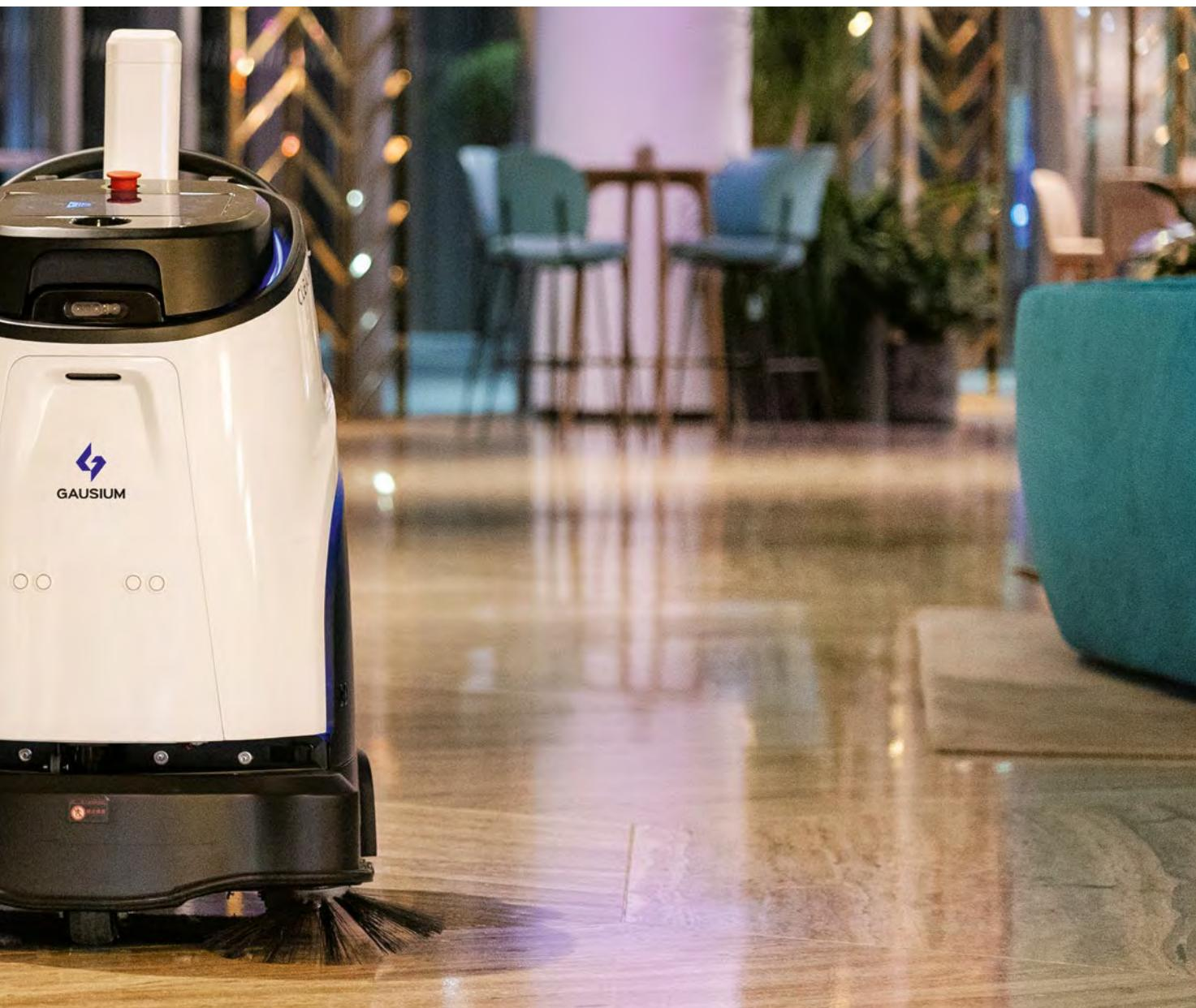
bürste dringt besonders tief in die Teppichfasern ein und befördert selbst hartnäckige Verunreinigungen aus tieferliegenden Gewebeschichten nach oben. Mit Hilfe der drei Saugmodi – leicht, mittel und stark – hat der Schmutz keine Chance. Dank den Seitenbürsten und seinen hochpräzisen Sensoren ist der autonome Roboter in der Lage auch im Bereich von Kanten mit Null-Abstand zu reinigen.
