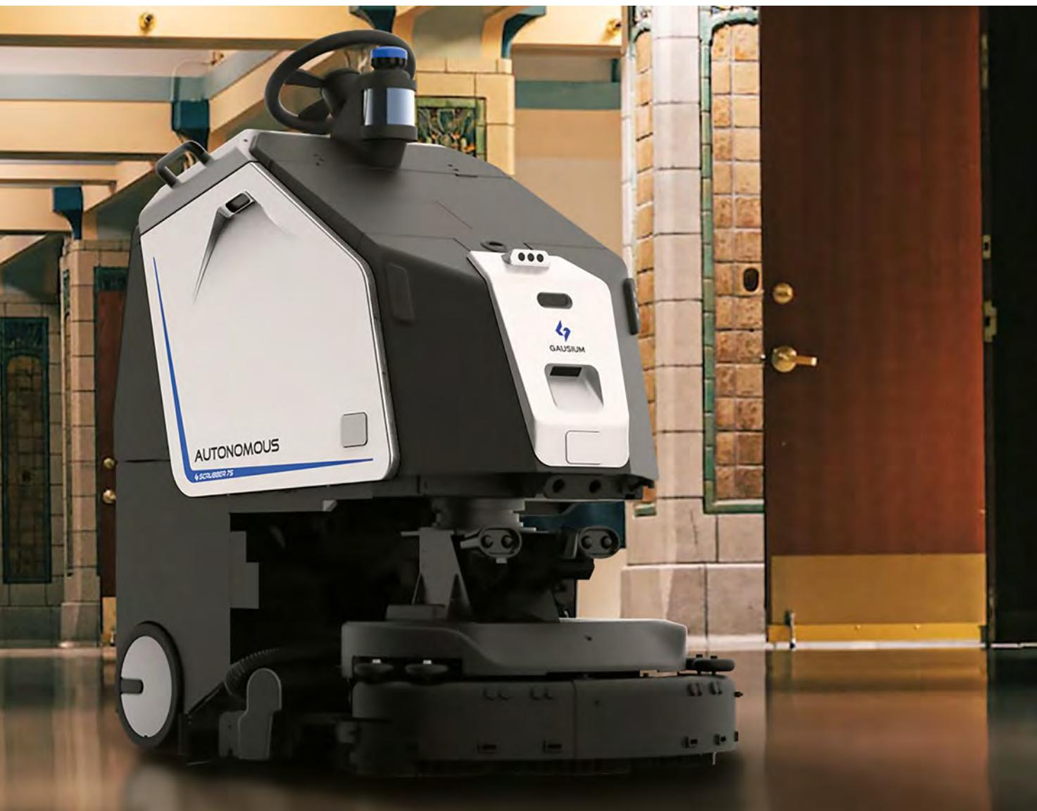
80 Prozent durch effizientes Recycling. Die autonome Navigation erkennt Hindernisse und findet dennoch den effizientesten Reinigungsweg. Der langlebige Akku sowie die Fähigkeit, eigenständig zur Ladestation zurückzukehren und die Arbeit nach dem Aufladen und Wechseln des Wassers fortzusetzen, maximieren die Reinigungszeit, ohne dass menschliches Eingreifen erforderlich ist.
