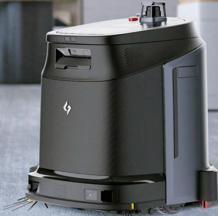
bürste und hochpräzise Sensoren, kann Phantas Kanten mit Null-Abstand reinigen. Kompaktheit sowie branchenführende Navigationsalgorithmen und leistungsstarke Kantenreinigungskapazität garantieren ein gründliches Reinigungsergebnis.
